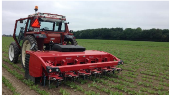
Markrobotten spændes efter en traktor, der trækker robotten med op til fire kilometer i timen. (Foto: Rikke Olsen DR)
